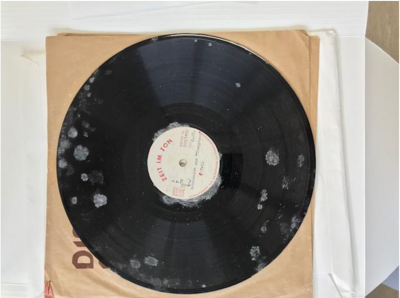
Abbildung 1. Schimmelbildung auf der Oberfläche einer Direktschnittplatte in Folge falscher Lagerung. Bild: Historisches Archiv der Stadt Köln.
